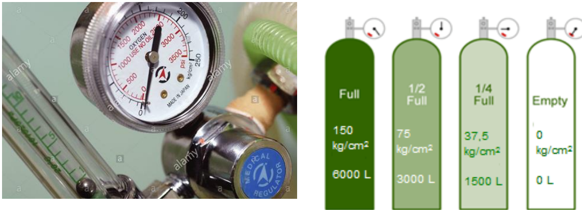
Hình 1: Đồng hồ đo áp lực oxy và cách ước tính lượng oxy trong bình. Nguồn: https://www.google.com/medical-gases-storage-and-supply-
